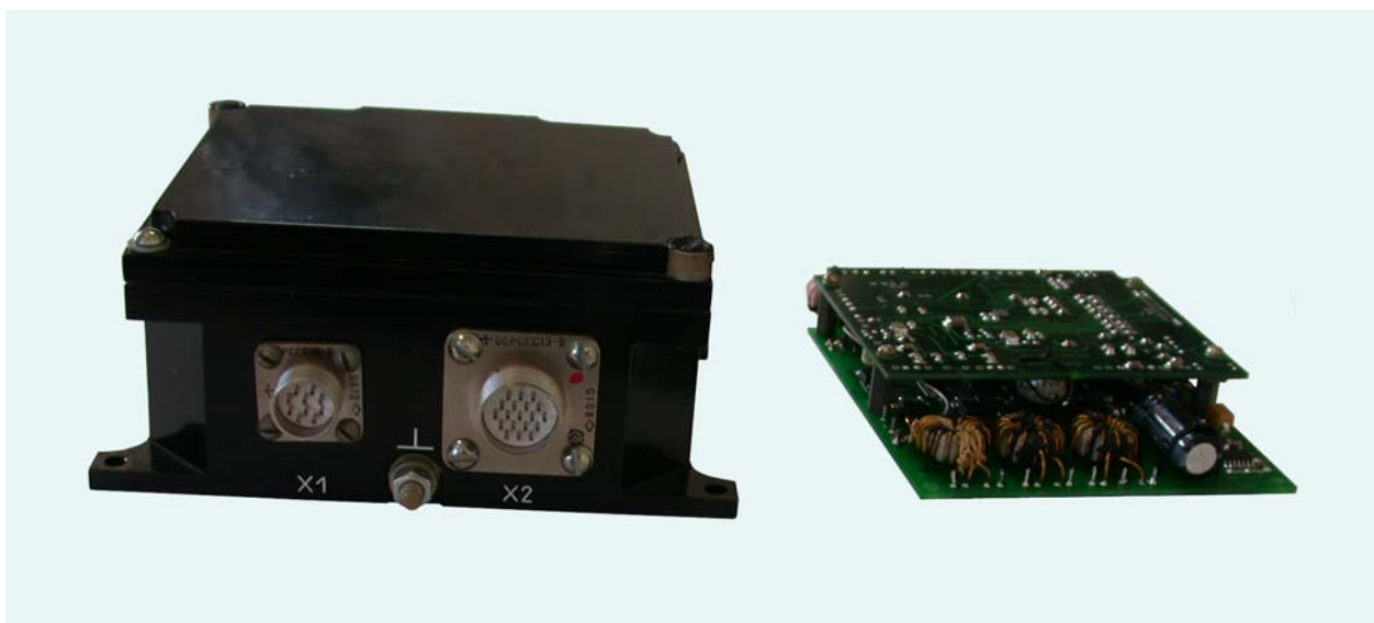
Рис.12 БУ в бескорпусном исполнении в сравнении с БУ базовой МКС 3-го класса.
